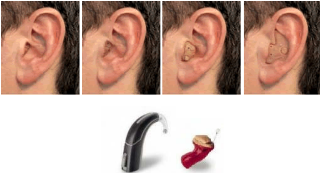
Abb. 4.3-g: Hörgeräte unterscheiden sich bezüglich Bauform und Technologie. Hörcomputer der Fa. Phonak 70 (links) Hinter-dem-Ohr-Modell 71 (HdO) bzw. (rechts) Im-Ohr-Modell (IO) 72
